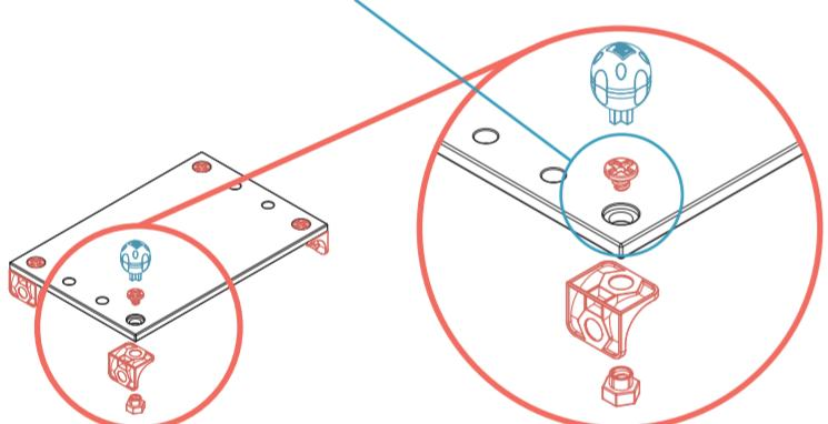
横板ナットと平ボルトを使って、幅の広い方の端部穴あき板①の四隅にベース
